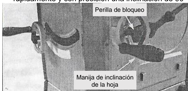
Figura 45: Manija de ajuste de la inclinación de la hoja.
