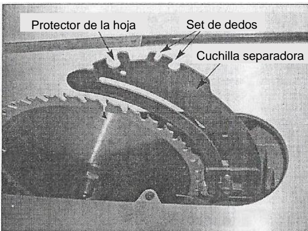
Figura 33: Fijación del protector de la hoja y los dedos anti-retroceso.
